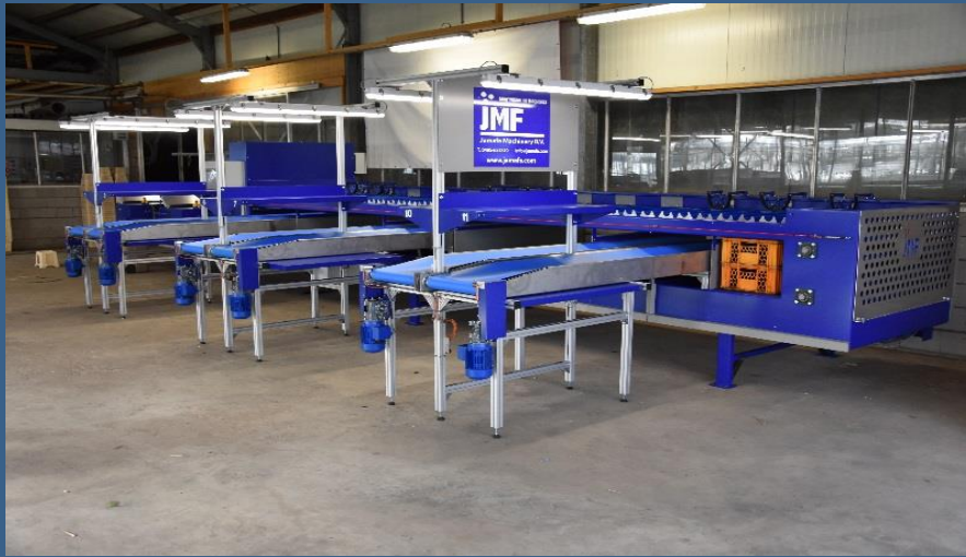
Jamafa Universelle Sortiermaschine mit Auslaufband für Amaryllis
